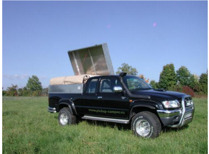
Der Deckel bleibt in dieser Schräglage offen.
