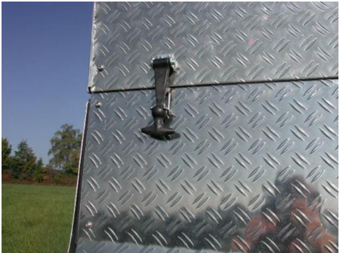
Gummihalterungen halten den Deckel geschlossen
