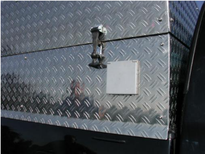
Eine CEE-Eingangssteckdose ist auch schon da.
